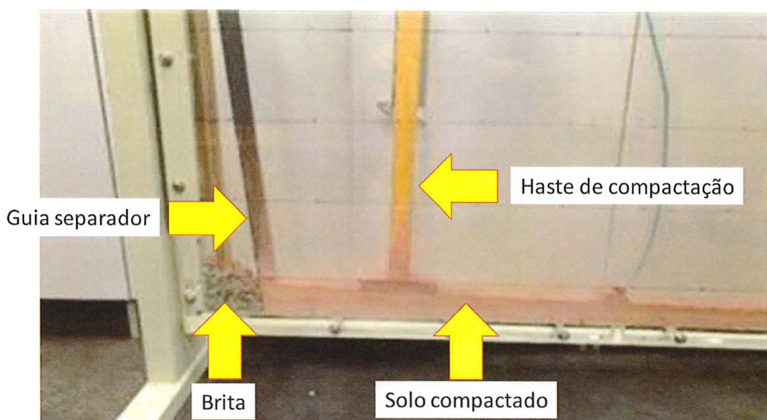
Figura 11 – Tanque de acrílico utilizado na construção do talude.
