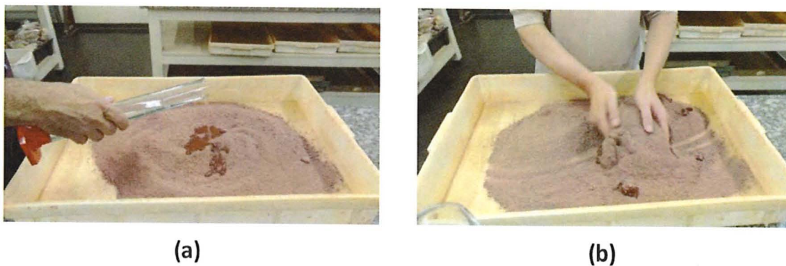
Figura 10 – Preparação do solo a ser utilizado na montagem do talude
